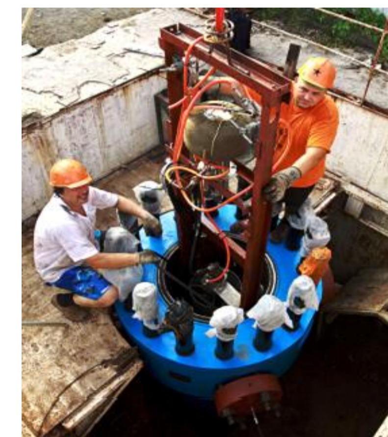
Тест-камера для имитации глубин океана до 9000 м. Test chamber to simulate ocean depths of up to 9000 m.
